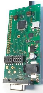
· 02-串行BD 串行通信板 (支持RS-232C/RS-485/USB串行通信)
