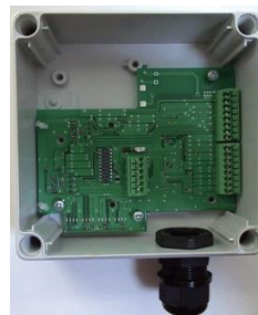
· 02-16swRX-NWP 防水盒装 16接点用一触式端子台* (16路开关/环回/8路应答, 双向兼容)
