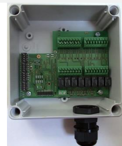
· 02-16swRL-NWP 防水外壳内置 带16接点继电器的端子台 (16路开关/环回/8路应答, 双向通信支持)
