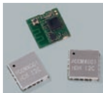
無線モジュール
