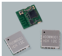
無線モジュール
