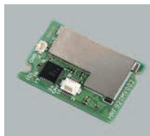
無線モジュール
