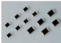
耐サージ形高電力チップ抵抗器
