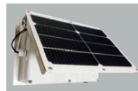
SPRC2（屋外型ソーラー・無線モジュール/LTE-M/LPWA・センサソリューション）
