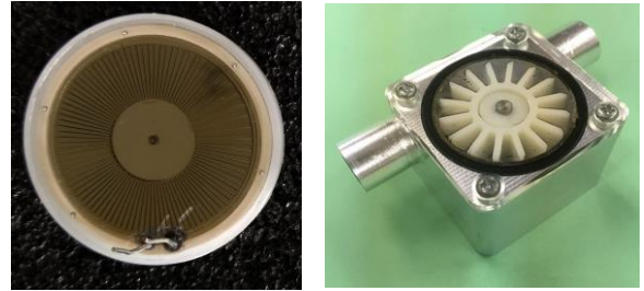
回転型エレクトレット発電モジュール
