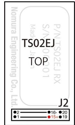
J2-12 にはステータス LED を実装します。動作状態のモニターおよび各種設定項目をセットする時に使用します。出力電圧が 2V なので、順方向電圧 (Vf) の低い LED を使用するか、トランジスタのドライブ回路を付加して希望する負荷を使用します。
