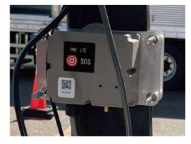
この専用端末を使用することにより、**稼動、** 位置、危険運転検知の情報を取得すること
